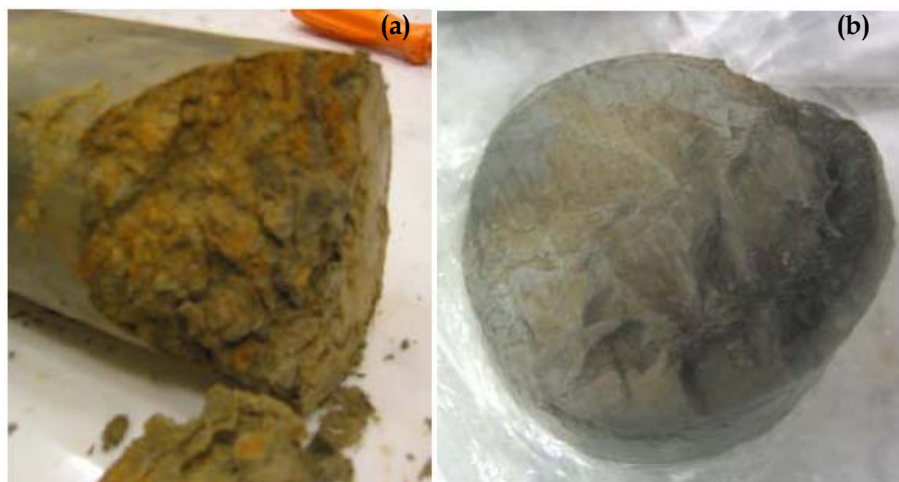
Fig. 1.4 - Le differenti mesostrutture di argilla avana (a) e argilla grigia (b) (da Silvestri et al., 2006).
