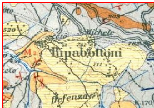
Fig. 3.1 stralcio del foglio geologico in cui ricade il Comune di Ripabottoni.
