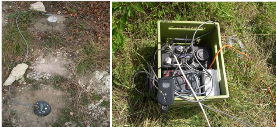
Figura 7 - A sinistra: sensori della rete temporanea (in basso il sensore accelerometrico). A destra: acquisitori Reftek 130 6 canali e sistema GPS integrato.
