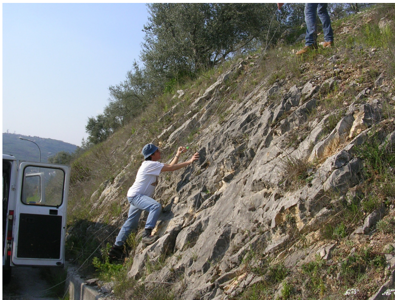
Fig. 14 – Ammasso frantumato (classe D) in corrispondenza della sella morfologica della dorsale di Monte S.Giovanni campano (in alto), ammasso tabulare (classe A) in corrispondenza di Colle S.Marco (in basso).
