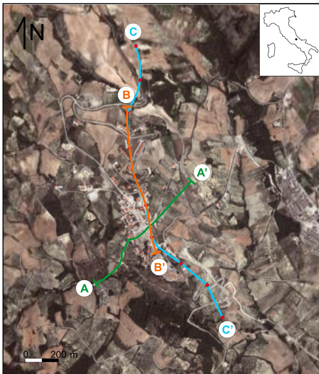
Fig. 2.1.1 – Vista satellitare del Comune di San Giuliano di Puglia (CB) con ubicazione dei profili delle tomografie di resistività elettrica AA', BB' (sistema di acquisizione multielettrodo) e CC' (sistema di acquisizione manuale). I cerchietti rossi indicano la posizione delle stazioni di misura della ERT CC'.
