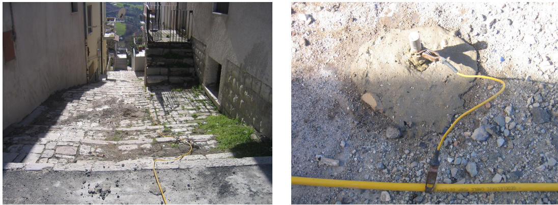
Fig. 2.1.2 – Foto di un tratto del profilo di acquisizione AA' passante su aree pavimentate (sinistra) e dettaglio di un foro riempito con bentonite con relativo elettrodo di misura (destra).
